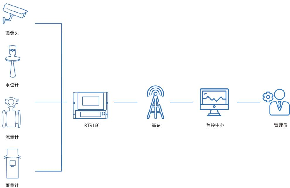
在水文监测系统中，RT9160工业数采终端采集监测点的各类前端传感器（如水位计、闸位计、流量计、电能表和视频等）数据，以相互补充的形式进行水位、流量等信息采集，利用4G/5G无线网络或有线网络，实现监测点与监控中心之间的信息传输，实现水文信息采集、传输、处理，汇入到水文监测数据库。同时，提供现场视频图像，加以辅助判定，为系统管理人员及环保部门提供真实可靠的雨水情信息。水文监测系统为水文测站站网及基础设施建设，密切监控河流汛情，提高水文监测能力和预报精度提供科学支撑。
